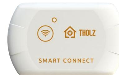
Para visualizar se o Smart Connect está conectado ao TSZ, mantenha pressionada a tecla “A” por aproximadamente 2 segundos
