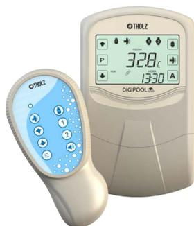
O DIGIPOOL TOUCH é um equipamento projetado para automatizar o aquecimento solar, filtro e realizar o controle de iluminação RGB ou monocromático de piscinas. Atua no controle da circulação da água através do diferencial de temperatura entre a piscina e os coletores solares, também é compatível com trocador de calor e sistemas hidráulicos com uma ou duas bombas. Acompanha um módulo RF externo para recepção de sinal do controle remoto.
