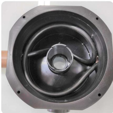
**2º** Puxe o cabo de alimentação dos refletores e retire a capa externa de isolamento, tomando cuidado para não danificar as veias internas. O tamanho deve ser suficiente para realizar as emendas.
