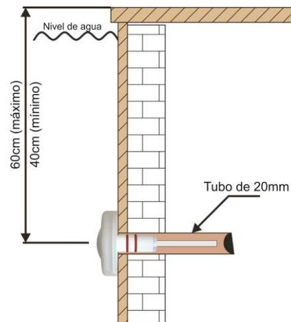
**IMPORTANTE:** El anillo O'ring no debe ser retirado bajo ninguna circunstancia, ya que él garantiza el sellamiento del agua con relación a las tuberías.
